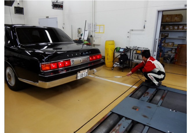
オイル・エレメント交換前の排気ガス測定②
