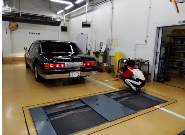
オイル・エレメント交換前の排気ガス測定①
