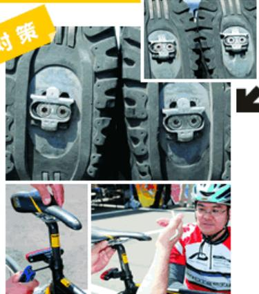
長谷川さんはMTB用のSPDペダルを使用中。クリートが小さいのでロード用より調整がシビアだ。クリートの前後位置や少しの角度のズレによって、ヒザから下の筋肉やヒザ関節のストレスになる。クリートがかなりつま先寄りだったので、ペダルシャフトの中心より母指球が2mm後ろになるよう移動。角度は足の自然な向きに合わせ、逆ハの字に変更した。サドルも7mmほど下げた。
