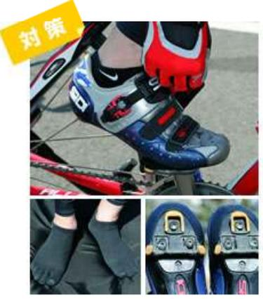
まずはストラップを緩める。きつく締めるものと思っっているライダーも多いが、脱げないギリギリくらいの強さで締めればOK。続いて素足で足踏みをしてもらい、左右の足の向きが逆ハの字になるのに合わせてクリート位置を調整。自然な足の向きに設定することで、関節や靭帯、筋肉へのストレスが減る。よりパワーを発揮できるよう、サドルを20mm後ろへ、腰の位置が遠くなった分高さを7mm下げた。
