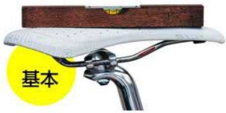
●すべてのサドルの基本位置が水平。この状態で乗り込むことで、痛い箇所を洗い出していく。水準器があればベストだ
