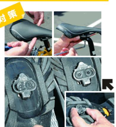
写真左上で指している部分に骨が当たっているのが原因、と藤下は診断。そのため、サドルの前後位置を1cmほど下げ、角度を水平よりやや前下がりにセッティングした。また、右足のペダリングにクセがあるため、クリートを調整することでペダリングの偏りを解消し、サドル右側にかかる圧力を分散させた。さらに高すぎるサドル位置を1cmほど下げ、太ももの筋肉を有効に使えるように。
