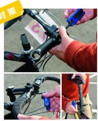
サドルとハンドルバーの落差が100mm近くあり、体格的にも体力的にもキツすぎた。そこでその場でできる方法として、ステムを天地反対に入れ替え、さらにコラムスパーサーをすべてステムの下へ移してアップライトポジションに変更。サドルとステムの落差を60mmに。ハンドルの角度とブラケットの位置を1mm以下の単位で調整して、フラットな面を作って手のひらへのストレスも解消した。
