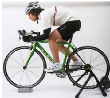
今回はベストなハンドル位置を探すための手順をより細かく説明します。ハンドル周りのベストなセッティングのために意識を置くべきポイントは、ヒジとヒザ。まずサドルにまたがった状態から、クランクを水平にします。そこから下ハンドルを握ってみて、ヒジを水平にした時にヒザが重なる位置を探して下さい。真横から見たときにヒジの骨とヒザのお皿がわずかに重なる程度の接点が見つかれば、その位置がまさにベストなセッティングです。
