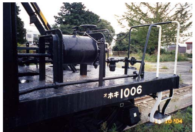
写真8 KDブレーキ装置(三動弁側)
