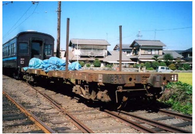
写真12 K三動弁を使用の貨車、チキ300形 (広軌車軸、バッファー穴付き)
