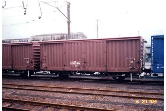
写真1 K三動弁付きのワム80000形貨車
