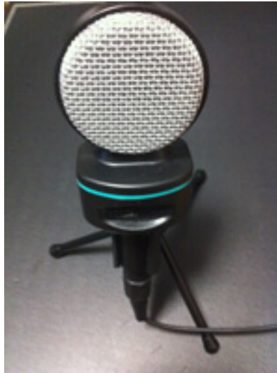
図 8. 500 円くらいの安マイク（実はかなりスグレモノのコンデンサマイク）
